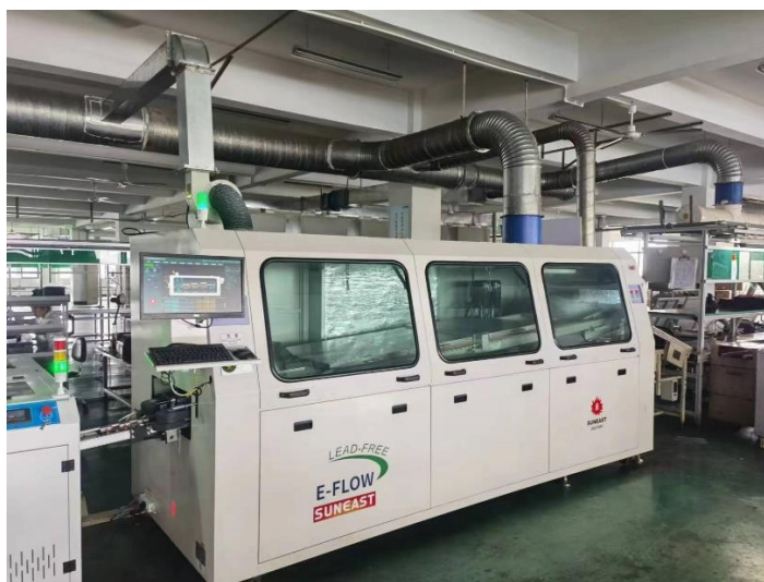
图 2-7 项目使用波峰焊锡机
