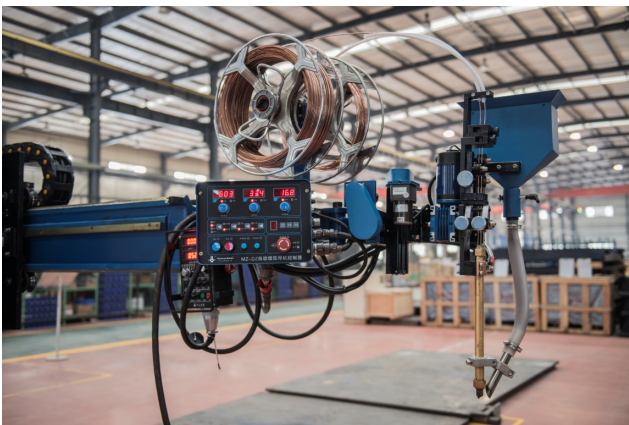
MZ-D2配套埋弧焊自动焊接中心
